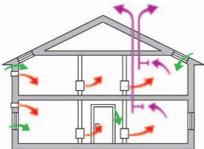
Abb. 3 Ventilatorgestützte Lüftung, mit Installationsschacht
