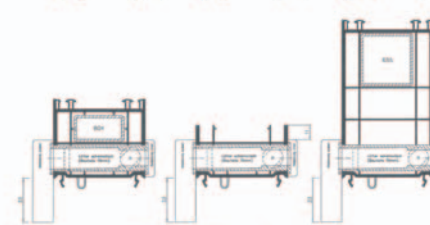
Bild 11 Einbauvariante 70 mm KBE und Kömmerling
