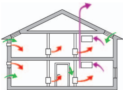
Abb. 2 Freie Lüftung, Schachtlüftung
