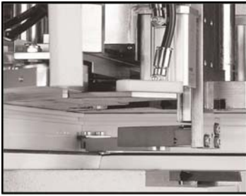
Abb. 1 maschinelles Niederhalten der Dichtung
