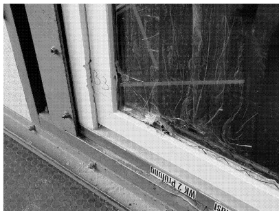
Bild 4 Schäden aus der manuellen Prüfung der Bandseite
