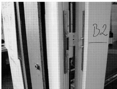
Bild 3 Band und Bandsicherung des Probekörpers
