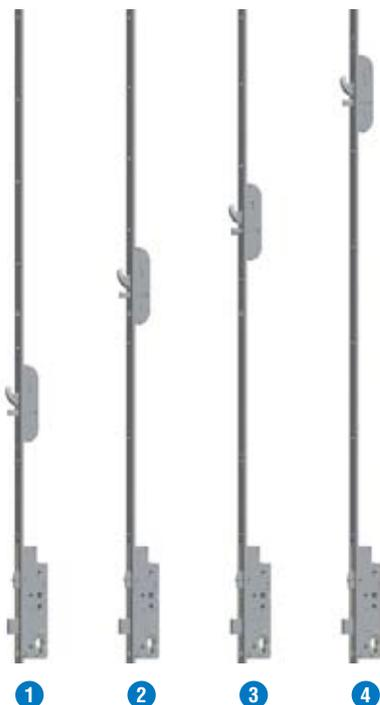
Position de boîtier au dessus de la Hauteur Poignée (HP 1050 ou 1020 mm)
